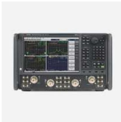
**网络分析仪** 是测试射频电路的专用设备,基本功能包括: S 参数, 损耗, 驻波比, 阻抗, 相位, 延时; 高级功能包括: X 参数, 变频与混频测量, 增益压缩。该设备是射频与微波测试核心设备, 大规模运用于: (手机、雷达) 天线、RF 集成电路、混频器、变频器、同轴射频连接器、线缆组件等产业领域。HP 为该设备发明商, Keysight (由 HP 演进) 为国际领先的网络分析仪制造商。我公司租赁资产以 Keysight 为主, 辅助德国 Rohde-Schwarz、日本 Anritsu。
