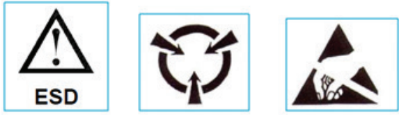
图 15. 功率传感器上使用的标签，显示了其对 ESD 的敏感性
