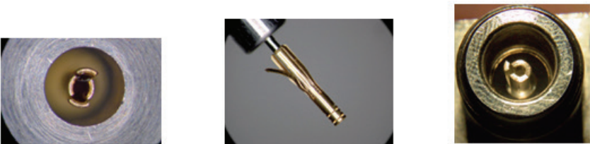
图 10. 受损的阴头连接器指杆
