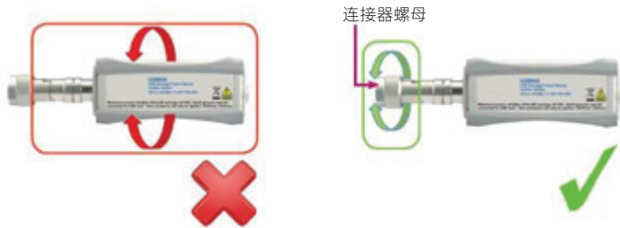
图 8. 正确进行连接以防损坏传感器
