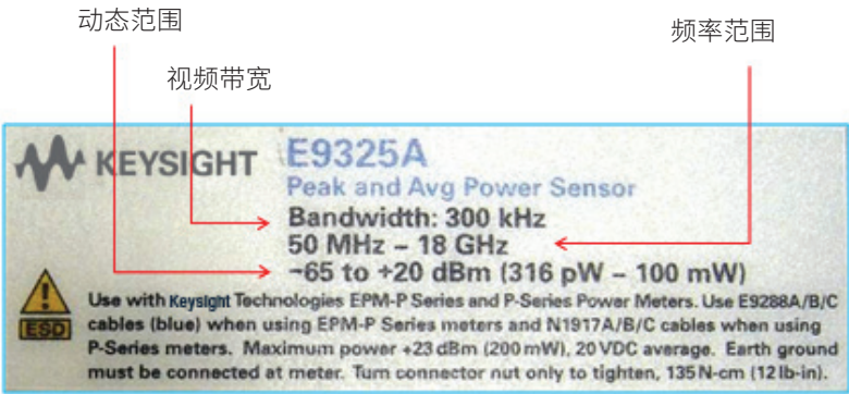
图 4. 传感器的产品标签指示了关键的技术指标和警告提示
